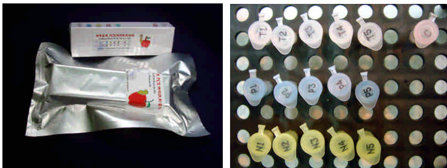
圖一、蘋果蠹蛾 PCR 檢驗試劑組。試劑組之外觀與內容物（左）；PCR 試劑組之反應試劑管（右）。右圖試管蓋上的標示分別為：T1~5（白色管）為五組不同之樣本測試組；P1~5（藍色管）為五組相對應的正對照組；N1~5（黃色管）為五組相對應的負對照組；C（粉紅管）為內對照組。
